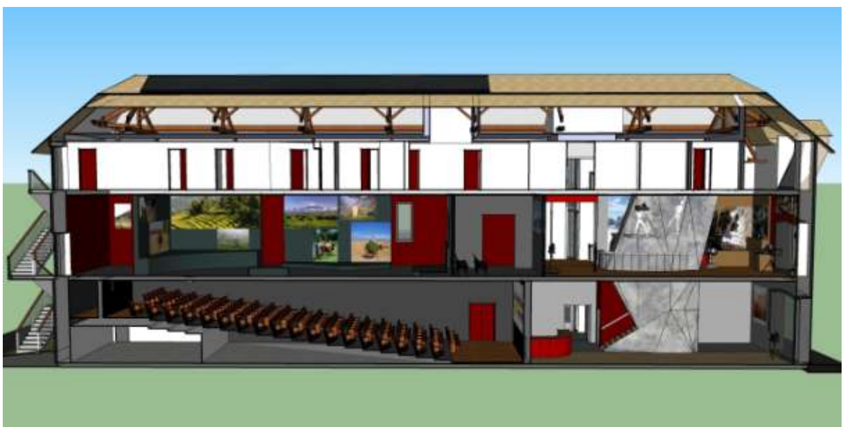
Coupe longitudinale sur l'ouvrage existant réhabilité
